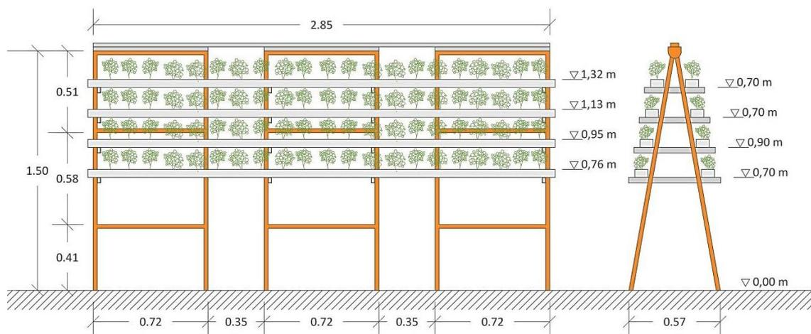
**Figura 12.** Especificaciones técnicas sobre las dimensiones del piloto de hidroponía. (Fundación CARTIF)
